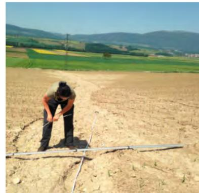
a) Détail pour la mesure de la rigole d'érosion
