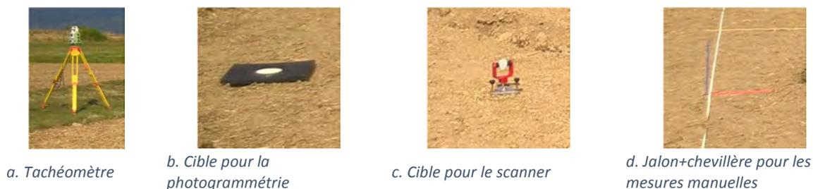
Figure 62 : Tachéomètre et cibles levés dans le référentiel commun (Source HEIG-VD)
