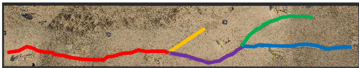
Figure 66 : Division de la rigole artificielle en 5 tronçons pour faciliter le calcul du volume
