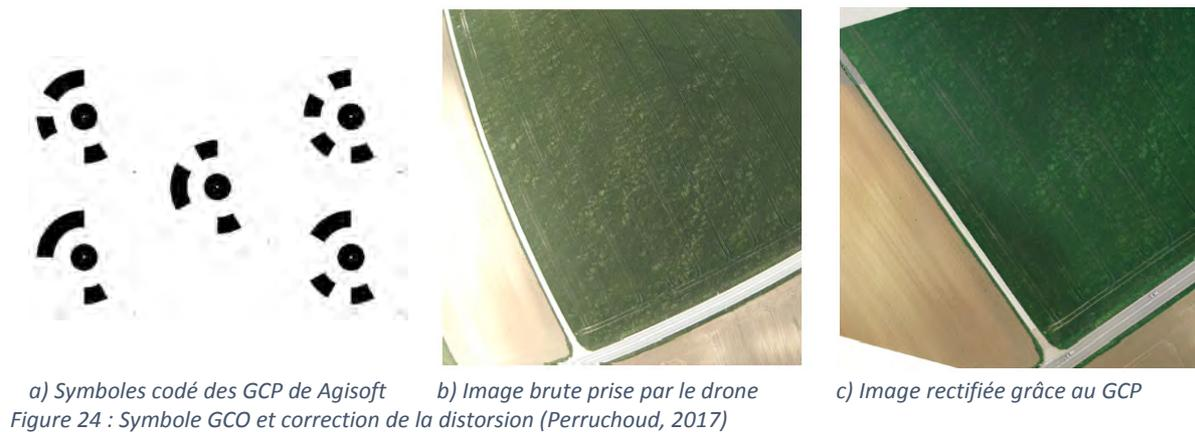
En fonction de la surface à survoler, il faut disposer plus ou moins de GCP. Cependant il y a encore des travaux de recherche à effectuer pour déterminer combien de GCP sont nécessaires pour influencer l'exactitude du géoréférencement. Ces GCP ne doivent pas être situés sur une ligne mais sur l'ensemble de la zone.
