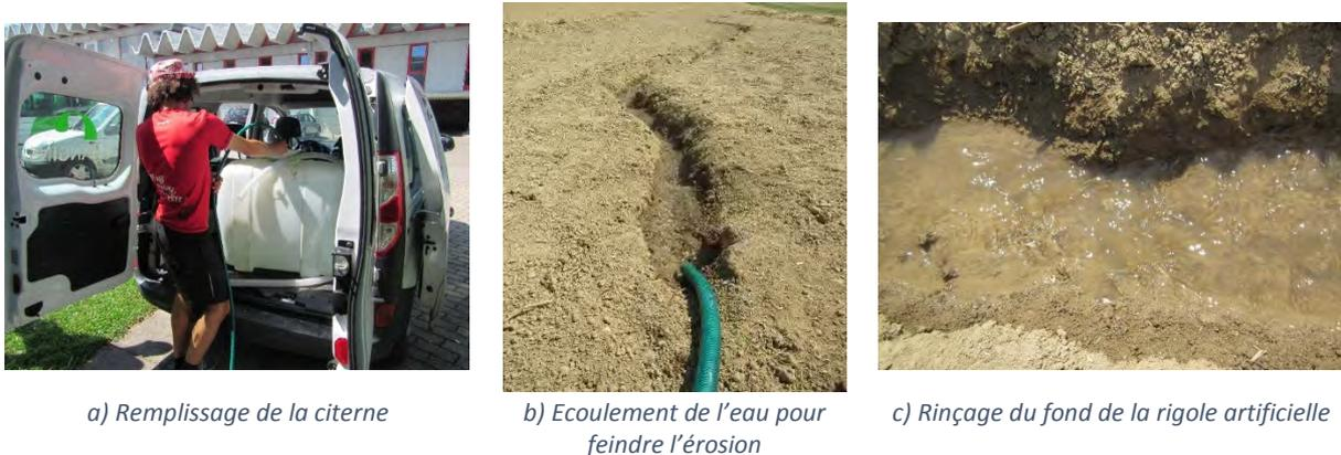
Figure 61 : Simulation de l'érosion dans le fond de la rigole artificielle (Source CHANGINS)
