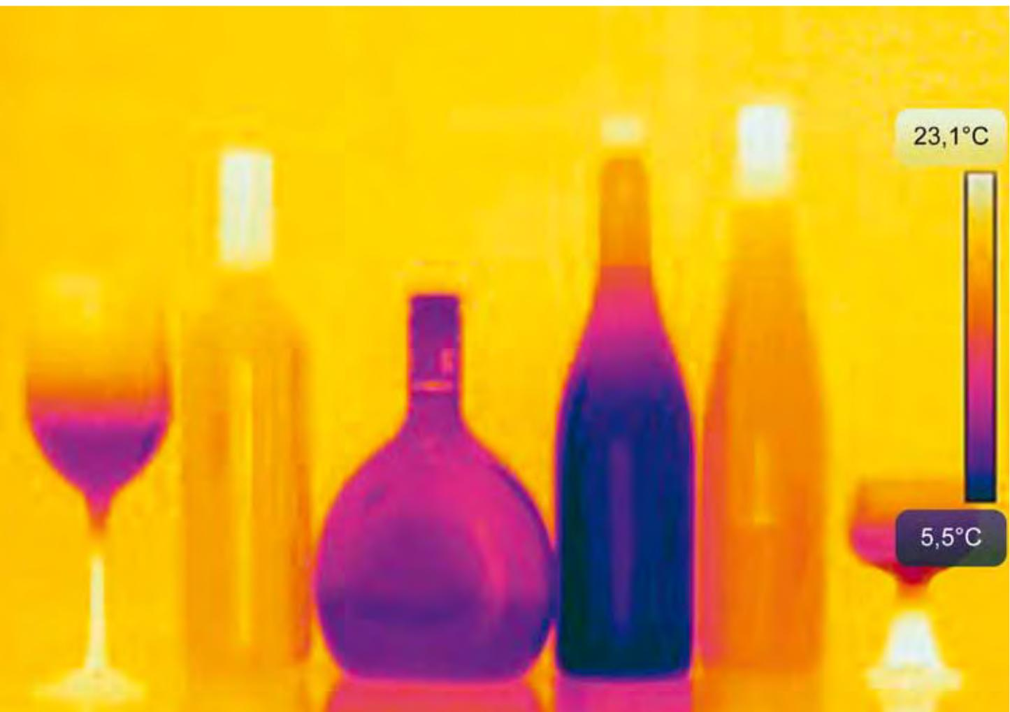
Tout comme la spectroscopie proche infrarouge employée pour le dosage des sucres et de l'alcool dans cette étude, la thermographie utilise le rayonnement infrarouge. En œnologie, elle permet d'obtenir des informations sur la distribution spatiale des températures, par exemple pour identifier les pertes de chaleur ou de froid dans la cave. Photo prise par Claude Willemin, Haute Ecole du paysage, d'ingénierie et d'architecture de Genève, avec une caméra thermique FLIR Systems T440 BX.
