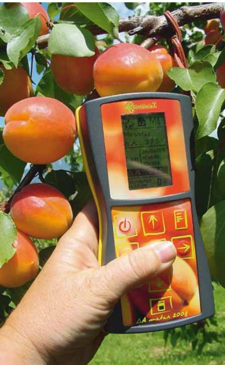
L'appareil portable DA-meter permet de mesurer par spectrométrie visible l'état de maturité des abricots au verger.
