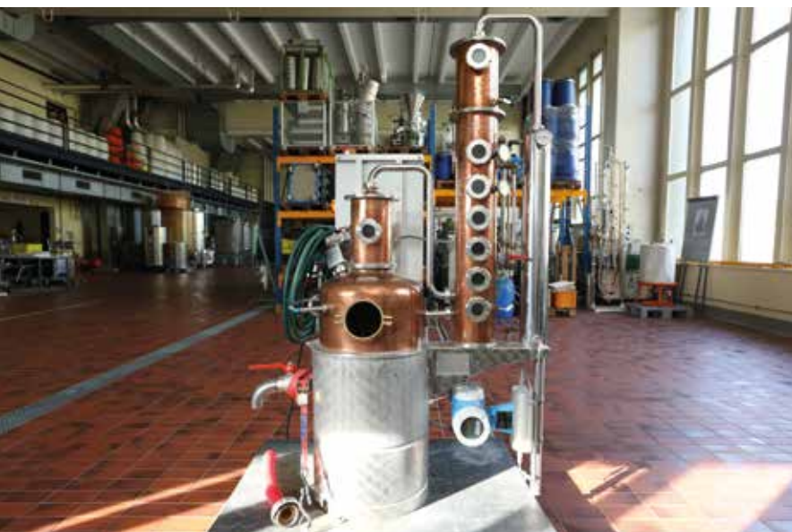
Un alambic automatisé est installé dans la cave didactique. Photo : CHANGINS
