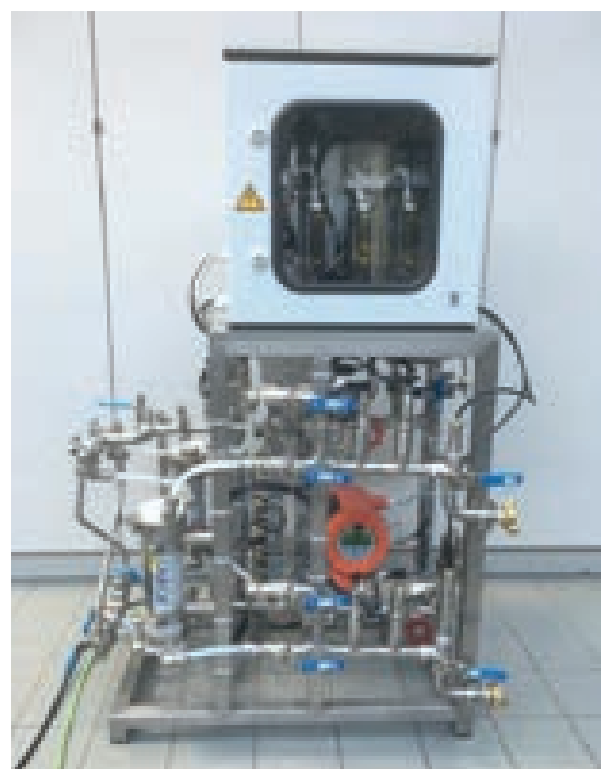
Contacteur membranaire automatisé développé dans le cadre du projet Wine C. Photo : CHANGINS.
