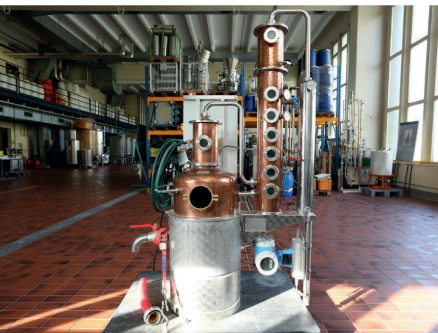
Alambic automatisé pour les besoins liés à l'enseignement et la recherche
