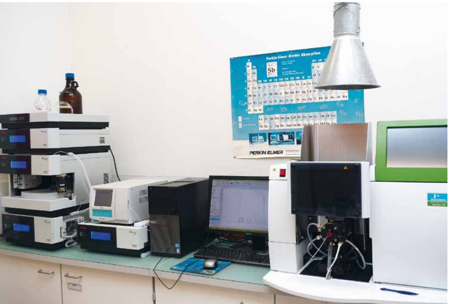
Chimie analytique à Changins: chromatographe en phase liquide à ultra-haute pression pour analyses diverses (à gauche) et spectromètre d'absorption atomique pour les éléments (à droite).
