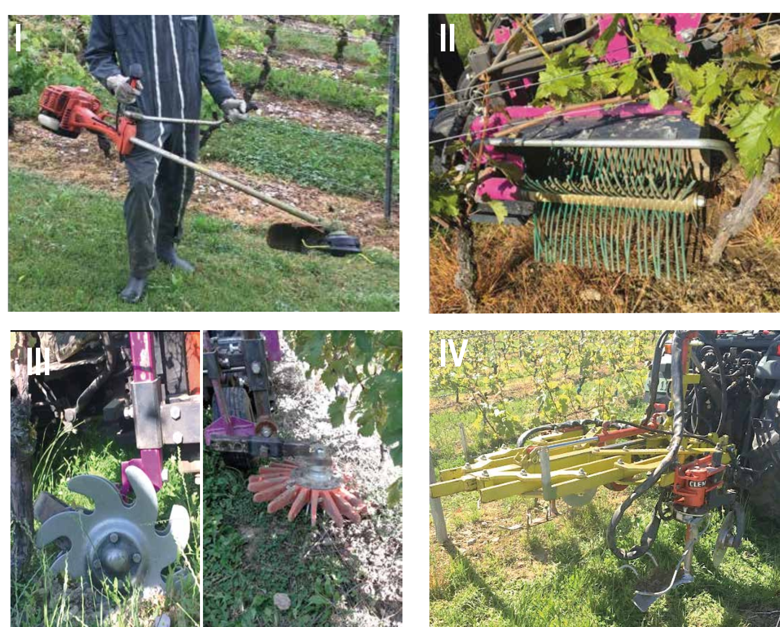
Fig. 1: Photos illustrant les quatre mode d'entretien alternatifs du cavaillon: I) Fauche; II) Brosses rotatives; III) Doubles disques et étoile de binage; IV) Lames.
