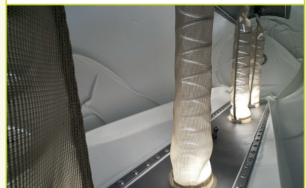
Figure 6. Pressoir à double membrane latérale et drains intérieurs centraux.
