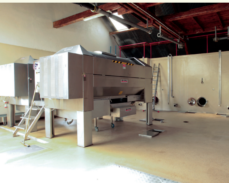
Figure 7. Pressoirs pneumatiques (cave Les Perrières, Peissy, CH).
